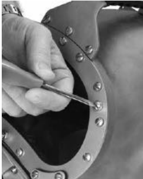
从面镜压板上卸下两个堵头螺钉
