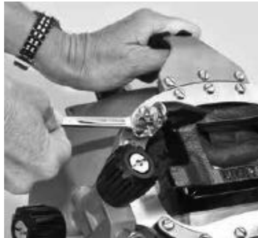
上紧焊接护目镜组件
