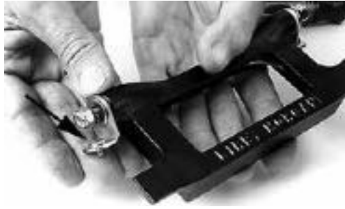
将螺钉穿过角码螺钉孔
